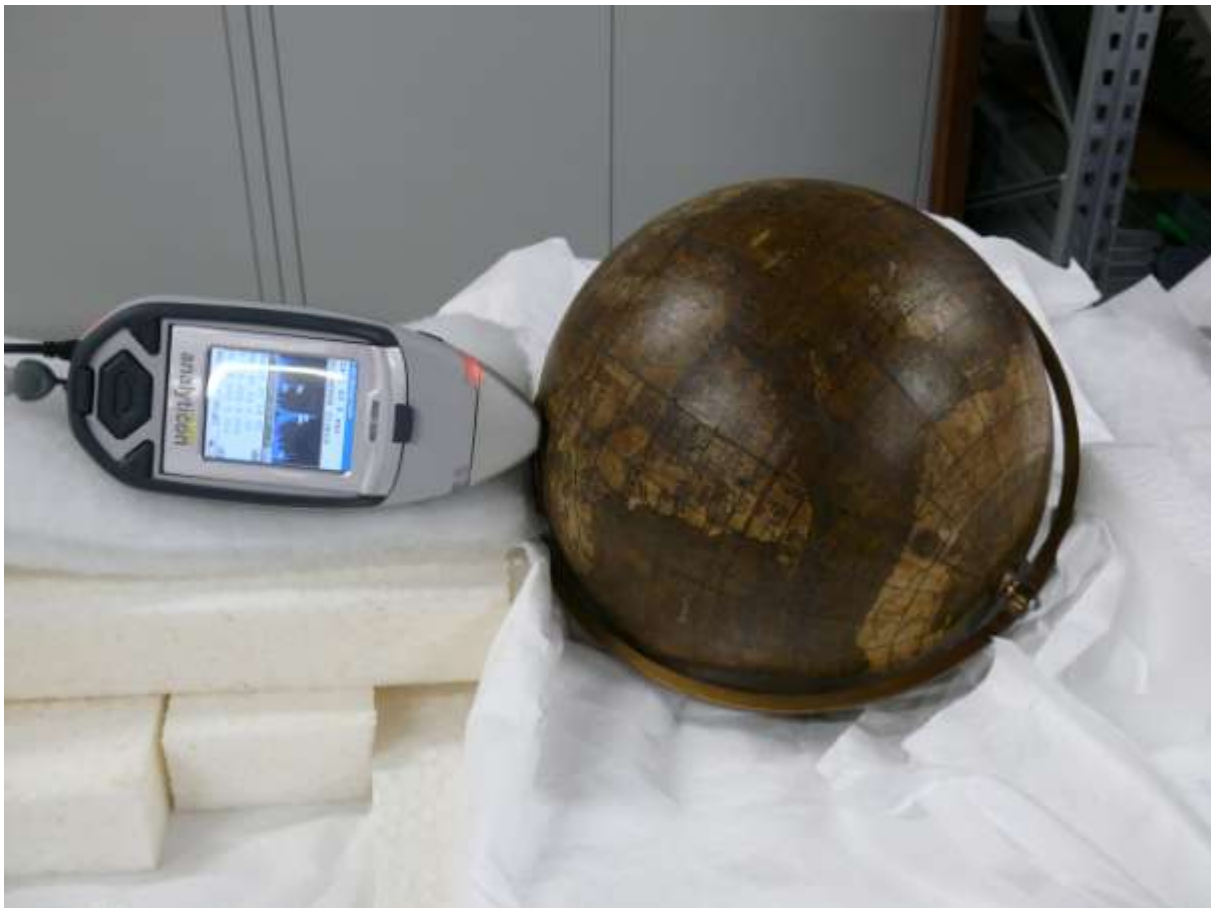
Abb. 7: Die Röntgenfluoreszenz-Analyse wurde mit Hilfe des transportablen Handheld-Gerätes durchgeführt.
