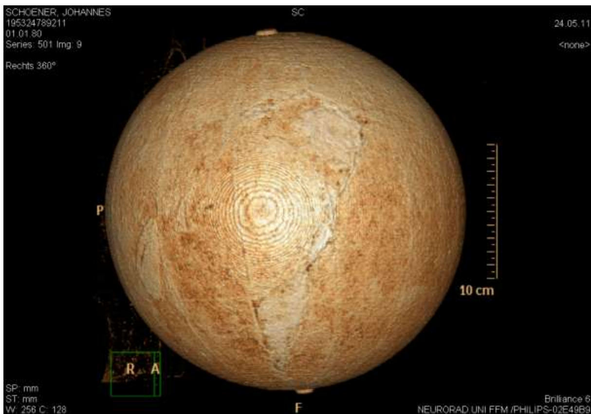
Abb. 8: Die dreidimensional bearbeitete CT-Aufnahme der Globuskugel („Surface Rendering“) macht den Verlauf der restaurierten langen Bruchstelle im Bereich des Atlantischen Ozeans deutlich.
